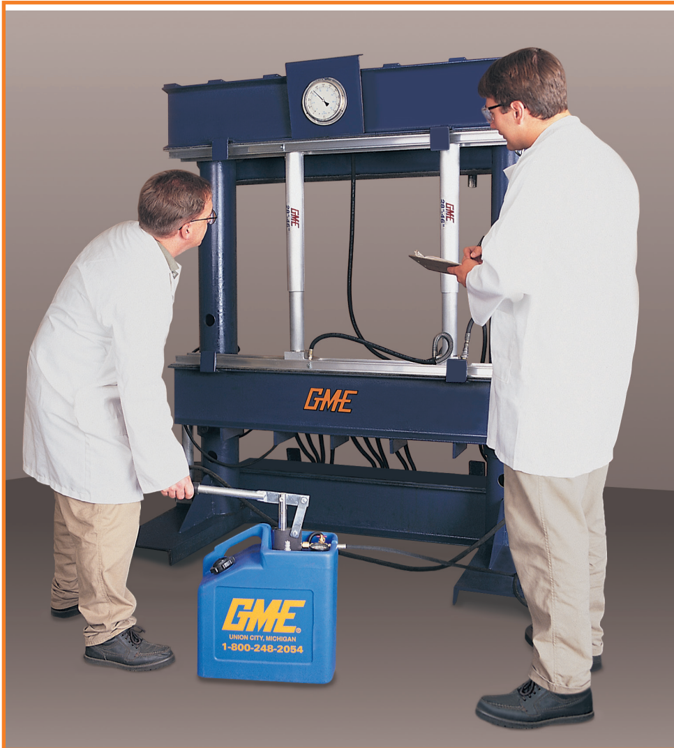
Uno de nuestros ingenieros profesionales matriculados realiza una prueba de presión en un puntal vertical antes del envío.
